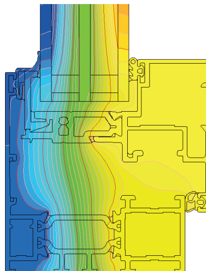
przykładowy rozkład izoterm dla systemu Ecofutura OC (EF214 + EF222)
