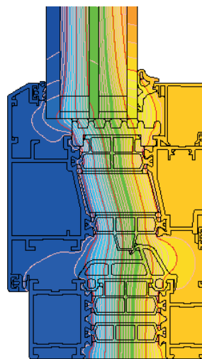
przykładowy rozkład izoterm dla złożenia ościeżnicy i skrzydła okiennego systemu SP OUT i+ (SP010 + SP521)
